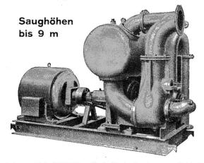
Leistung 1 bis 500 Liter/Sek. Kein Bodenventil. Keine Klappe im Saugstutzen. Keine Hilfs-Vakuum-Pumpe. Jederzeitiges automatisches Ansaugen auch nach Lufteintritt im Saugrohr. Keine reibenden, sich abnützenden Dichtungsflächen, daher unempfindlich gegen Sand, Schlamm und Kies.
