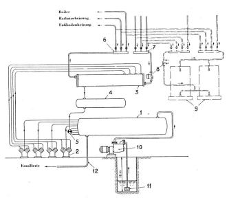
Fig. 33 Schema der Wärmepumpenheizung.
