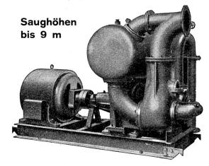
Leistung 1 bis 500 Liter/Sek. Kein Bodenventil. Keine Klappe im Saugstutzen. Keine Hilfs-Vakuum-Pumpe. Jederzeitiges automatisches Ansaugen auch nach Lufteintritt im Saugrohr. Keine reibenden, sich abnützenden Dichtungsflächen, daher unempfindlich gegen Sand, Schlamm und Kies.
