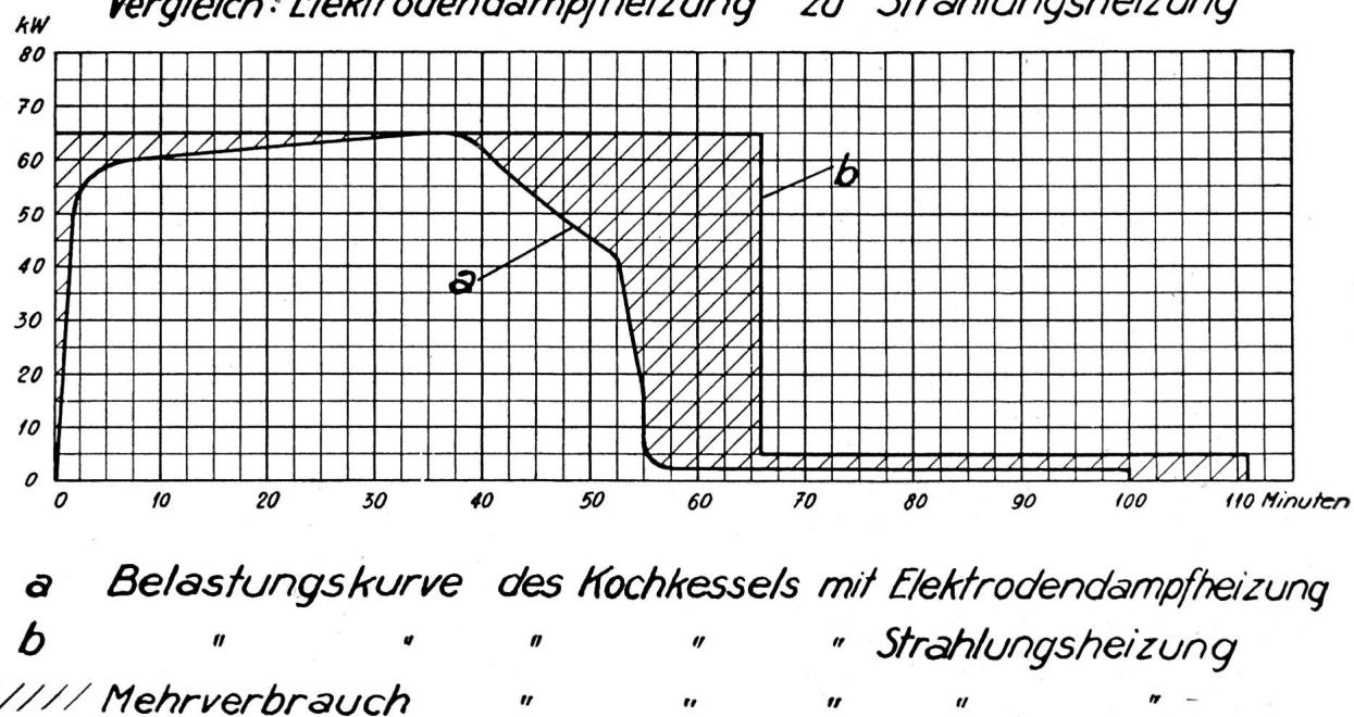
a Belastungskurve des Kochkessels mit Elektrodendampfheizung
