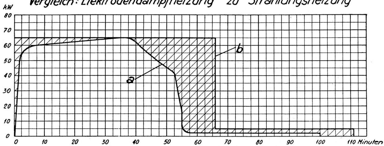
a Belastungskurve des Kochkessels mit Elektrodendampfheizung
