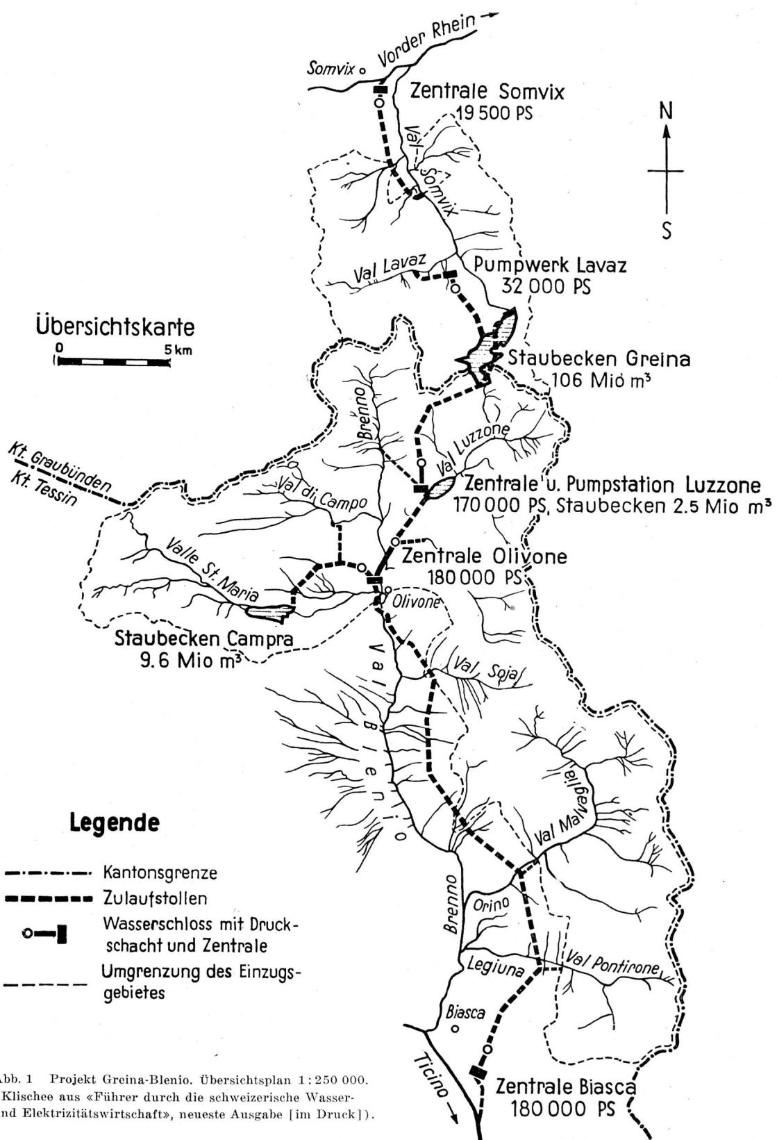
die Kronenlänge 375 m. Diese Sperre erfordert 70 000 m<sup>3</sup> Beton. Eine weitere kleine Absperrung kommt in der Richtung Somvixertal auf das Pässchen Carpet zu stehen und benötigt eine Mauerkubatur von 6000 m<sup>3</sup>. Für das Speichervolumen von 106 Mio m<sup>3</sup> ist also insgesamt eine Mauerkubatur von 1 084 000 m<sup>3</sup> erforderlich. Mit 1 m<sup>3</sup> Mauerwerk können somit nahezu 100 m<sup>3</sup> Wasser aufgestaut werden.
