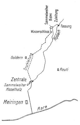
Abb. 1 Situationsskizze der neuen Kraftwerkanlagen.
