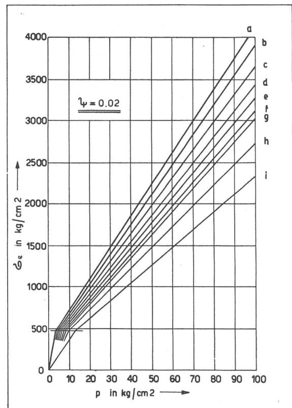
Man sieht sofort, dass bei guten Felsverhältnissen ( $\gamma \approx 2$ ,  $E_f \approx 200\,000 \text{ kg/cm}^2$ ) die Spannung in der Panzerung praktisch von  $r_f$  und  $\delta$  unabhängig wird. In diesem Falle wird also:
