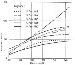
Abb. 3 Wasserwert der Schneedecke am 15. Februar der Jahre 1943 bis 1947 in Abhängigkeit von der Höhenlage ü. M.
