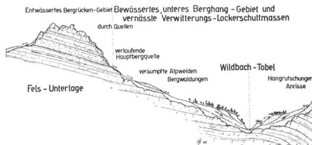
Abb. 12 Ein typisches, schematisiertes Berghangprofil mit Wasserabfluss und speziell Quellenverwässerung.
