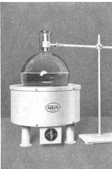
Fig. 21 Heizgerät für Glaskolben und Retorten.
