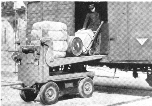
Fig. 23 SIG-Elektro-Plattformkarren mit Hubbrücke.
