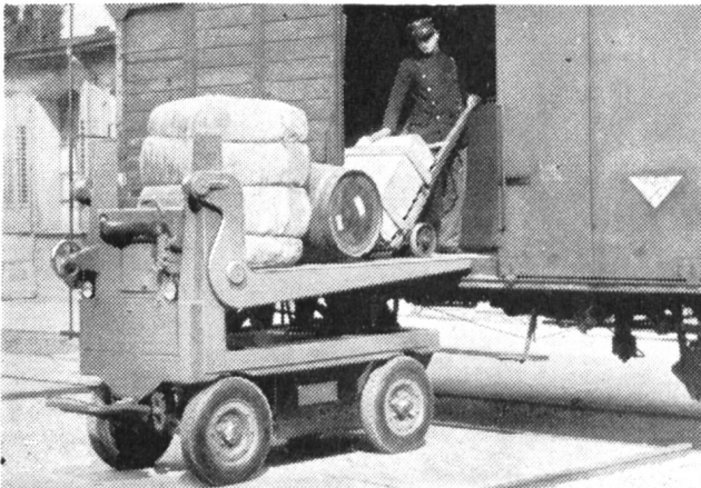
Fig. 23 SIG-Elektro-Plattformkarren mit Hubbrücke.
