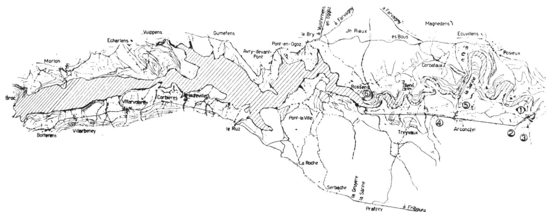
① Kraftwerk Hauterive, ② Wasserschloss, ③ Fenster, ④ Druckstollen, ø 5,0 m, ⑤ bestehender Stollen, ⑥ Stauwehr.
