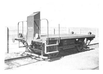
Abb. 3 Akkumulatoren-Kleintraktor 16 PS, Aktionsradius 600 tkm, Nutzlast 10 t.
