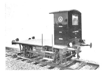
Abb. 4 Akkumulatoren-Kleintraktor 16 PS, Zugsgewicht 48 t<br/> auf 23 % Steigung.
