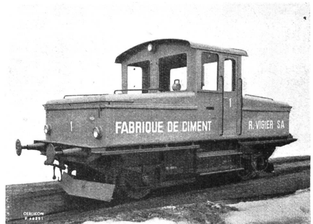
Abb. 2 Moderne Werklokomotive 100 PS, Aktionsradius 6400 tkm, Gewicht 25,5 t.
