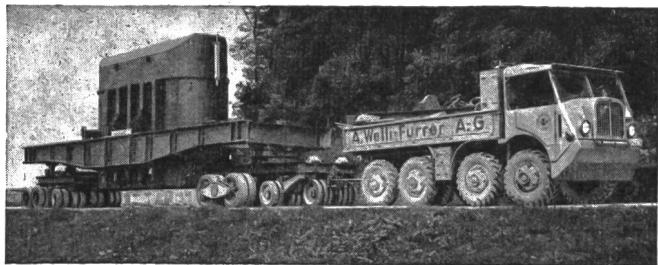
Transport eines Transformators von über 70 Tonnen Gewicht
