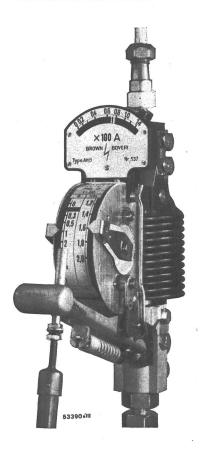
Fig. 12 Aufbau - Ampèremeter, Betriebsstromanzeige am Relais (A.-G. Brown, Boveri & Cie., Baden).
