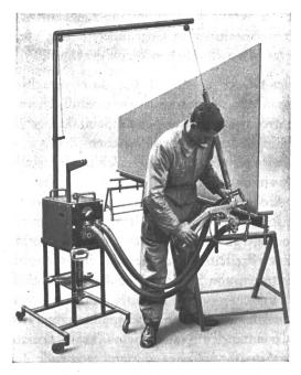
Fig. 20 Transportable Punktschweiss-Einrichtung mit beweglicher Schweisszange (A.-G. vorm. H. A. Schlatter & Co., Zollikon).
