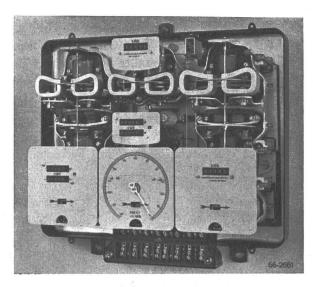
Fig. 24 Spezialzähler zur niederspannungsseitigen Erfassung von Wirkleistung sowie der Eisen- und Kupferverluste von Transformatoren (Landis & Gyr A.-G., Zug).
