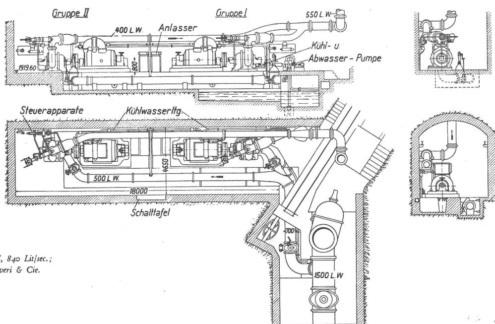
Abb. 13 Pumpenanlage, 4400 PS, 840 Lit/sec.;
