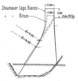
Abb. 6 Vergleich der erhöhten Lago-Bianco-Mauer mit der Ritomstaumauer. Maßstab 1:200.
