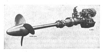
Abb. 2 Verstellbarer Schiffspropeller
