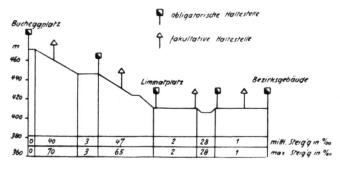
Abb. 1 Vereinfachtes Längenprofil der Fahrstrecke.
