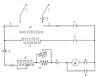
Abb. 5 Prinzipschema für Seriemotor.
