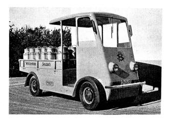
Fig. 13 Elektromilchwagen. Tracteur électrique pour transport de lait.
