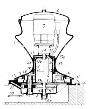
Abb. 3 Schnitt durch Jas Rangierspill Abb. 2.
