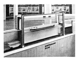
Abb. 7 Das Wasserbaumodell. Schmitt durch die Schiffahrtsschleuse. Versuchsanstalt für Wasserbau an der E.T.H.
