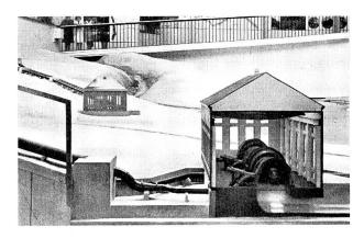
Abb. 3 Das Wasserbaumodell. Schnitt durch das Maschinenhaus der Hochdruckanlage. Versuchsanstalt für Wasserbau an der E. T. H.
