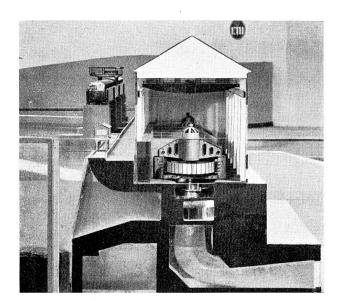
Abb. 5 Das Wasserbaumodell. Schmitt durch das Maschinenhaus der Niederdruckanlage. Versuchsanstalt für Wasserbau an der E.T.H.
