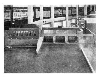
Abb. 6 Das Wasserbaumodell. Wehr und Maschinenhaus der Niederdruckanlage. Versuchsanstalt für Wasserbau an der E. T. H.
