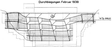
Abb. 22 Staumauer Schlagen. (Etzel.) Durchbiegungen Juni 1937 und Februar 1938. Abt. Wasserkraftanlagen.
