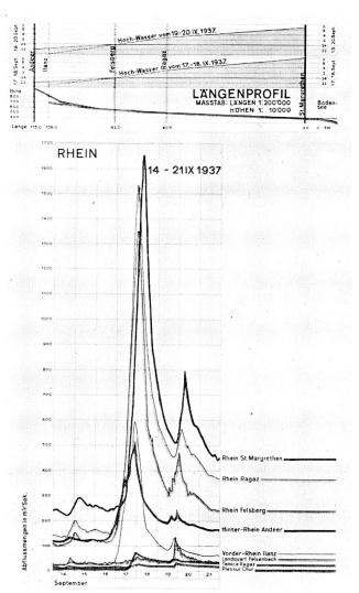
Abb. 13 Verlauf einiger charakteristischer Hochwasser. Rhein und Nebenflüsse von Ilanz bis St. Margreten. 14. Sept. bis 21. Sept. 1937. Zeitlicher Verlauf beider Hochwasserspitzen. Eidg. Amt für Wasserwirtschaft.
