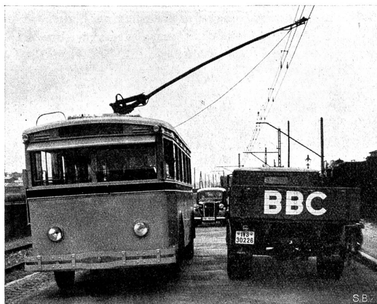
Abb. 29 Einstangen-Stromabnehmer und Vielfachaufhängung BBC.
