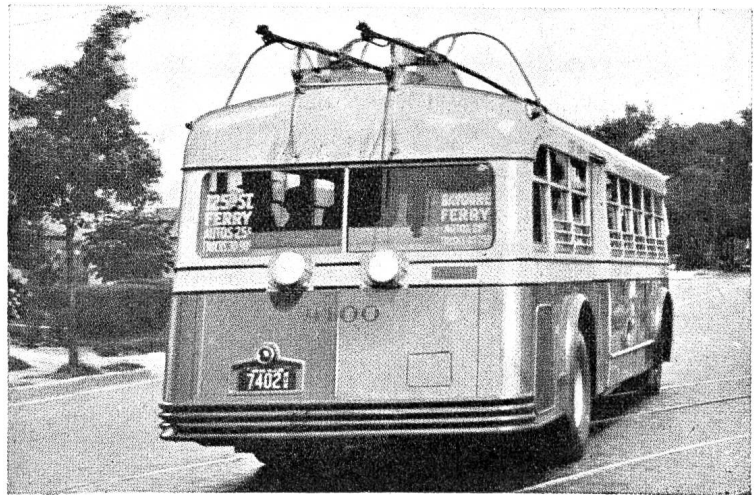
Abb. 33 Endgültige Bauart des in Newark entwickelten Zweikraftwagens. Das Bild zeigt einen der 430 vorhandenen Wagen mit abgezogenen Stromabnehmern als Diesellbus laufend.
