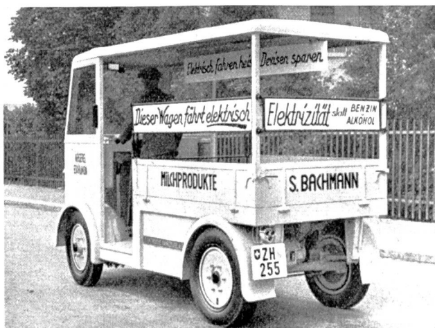
Fig. 47 Dieses Fahrzeug, ein Milchwagen in Eschlikon, Kt. Thurgau, mit einer Nutzlast von 1000 kg besitzt eine Geschwindigkeit von 20 km/h und einen Aktionsradius von 50—60 km pro Batterieladung. Der Wagen ist ausgerüstet mit einer Panzerplatten-Batterie, für die eine Garantie von 3 Jahren eingeräumt wird, in dem Sinne, dass die Kapazität nach Ablauf dieser Zeit noch mindestens 80% beträgt. Durch die Pneuberufung erhält der Wagen eine tadellose Abfederung, was auf die Lebensdauer der Batterie sich sehr günstig auswirkt. Der Erfolg, der am Tage der Stilllegung der übrigen Kraftfahrzeuge erzielt wurde, darf als ganz gebucht werden, denn überall wurde dem Fahrzeug die grösste Aufmerksamkeit geschenkt. Die Lieferfirma, Elektrische Fahrzeuge A.-G., Zürich-Oerlikon, konnte inzwischen verschiedene Anfragen entgegennehmen, die auf diesen Propaganda-Feldzug zurückzuführen sind.
