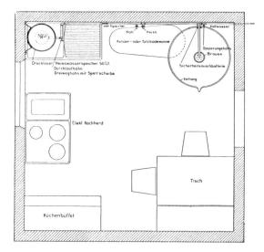
Fig. 11 und 12 Duscheneinrichtung in der Küche, unter Benützung eines bereits vorhandenen 50 Liter-Heisswasserspeichers.
