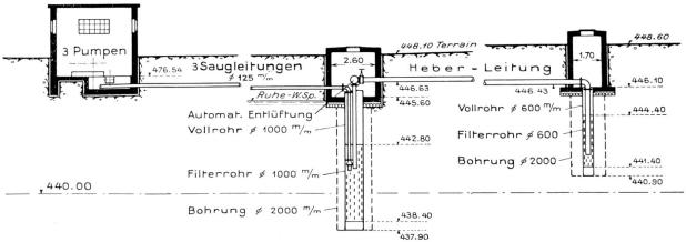
Abb. 67 Grundwasserversorgung der Fabrik von Maggis Nahrungsmitteln im Tösstal. Längsselmitt durch das Pumpwerk und die beiden Filterbrunnen. Maßstab 1:250.
