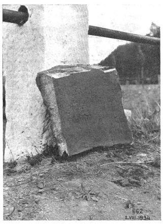
Abb. 10. Mexphaltbelag. Herausgespitztes Probestück. Außenseite.
