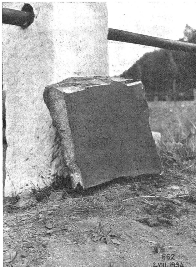
Abb. 10. Mexphaltbelag. Herausgespitztes Probestück. Außenseite.
