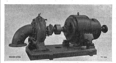
Einstufige Hochdruckpumpe mit geschweißter Fundamentplatte
