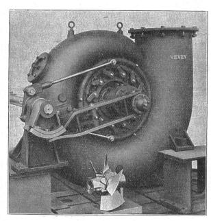
Chute 10,7 m.-Puissance, 77 ch.-Vitesse, 1100 t: min.
