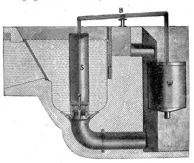
Fig. 1. Automatischer Grundablaß für Saugwirkung.
