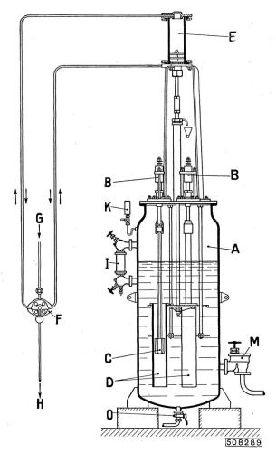
Abb. 27 Elektro-Dampfkessel für Hochspannung.
