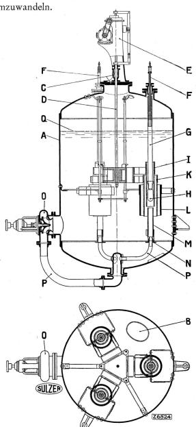
Schnitt durch einen Sulzer-Hochleistungs-Elektro-Abb. 28 kessel von 7500 kW.
