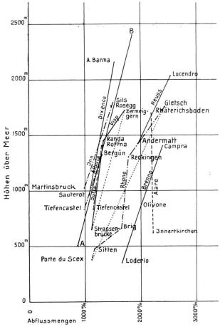
Abb. 2. Mittlere Jahresabflußmengen in Funktion der Höhe
