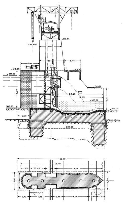
Abb, 5. Kraftwerk Albbruck-Dogern, Querschuitt durch die Oeffnung 3. Pfeiler IV. Maßstab: 1:300.
