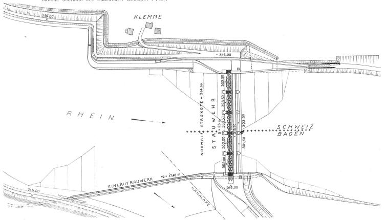
Abb. 3. Kraftwerk Albbruck-Dogern. Wehr und Einlaufbauwerk. Situation. 1:3000.
