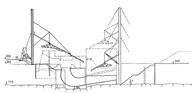
Abb. 17. **Kraftwerk Albbruck-Dogern.** Fundierung des Maschinenhauses. Schnitt A-B. Maßstab: 1:1500.
