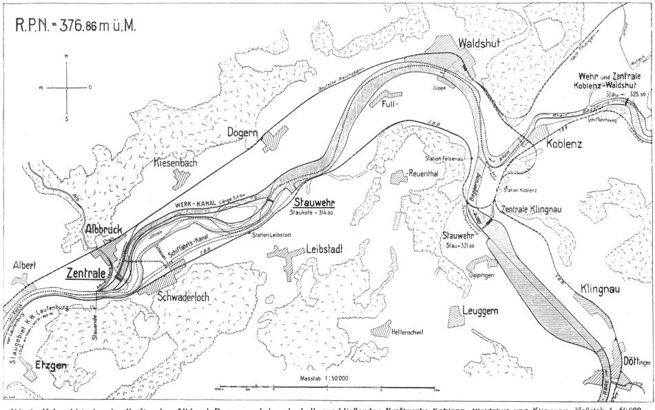
Abb. 1. Uebersichtsplan des Kraftwerkes Albbruck-Dogern und der oberhalb anschließenden Kraftwerke Koblenz-Waldshut und Klingnau. Maßstab 1:50000.
