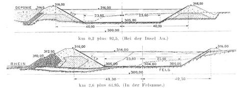
Abb. 9. Kraftwerk Albruck-Bogern, Querprofile durch die Dämme im Oberwasserkanal, Maßstab; 1:1150.
