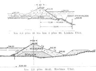
Abb. 2. **Kraftwerk Albbruck-Dogern.** Querprofile durch die Dämme oberhalb des Stauwehrs. **Maßstab**: 1:800.
