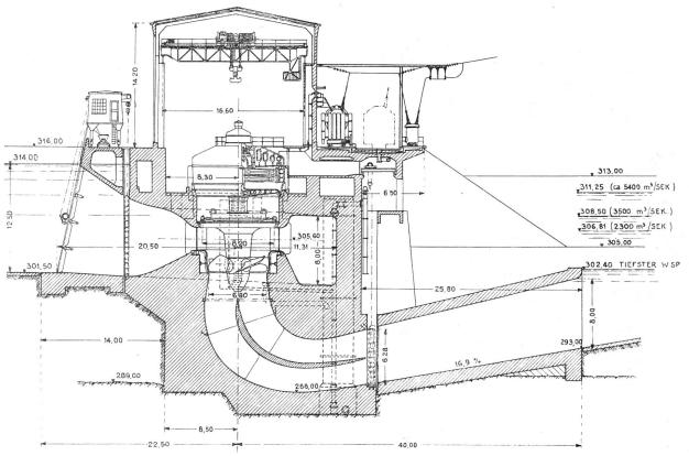
Abb, 13. Kraftwerk Albbruck-Dogern, Querschnitt durch ein Maschinenfeld, Maßstab: 1:500.
