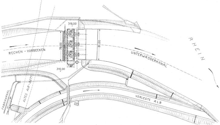
Abb. 10. Kraftwerk Albbruck-Dogern. Situation des Maschinenhauses. Maßstab: 1:3000.
