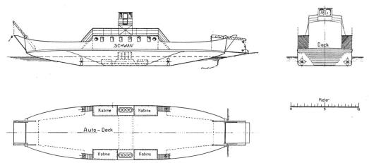
Abb. 1. Zürichsee-Fähre Meilen-Horgen. Ansicht, Grundriß und Schnitt des Fährschiffes.
