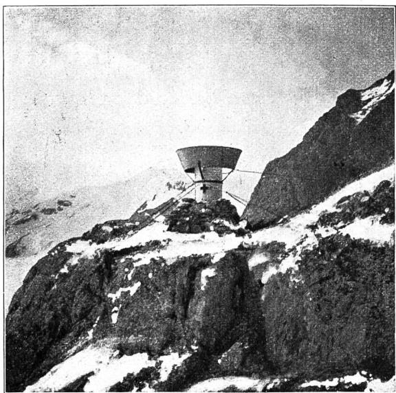
Abb. 1. Niederschlagssammler am oberen Rhonegletscher (2800 m) erstellt von der Schweiz. Meteorol. Zentralanstalt. (Derselbe Typ am Jungfraujoch)
