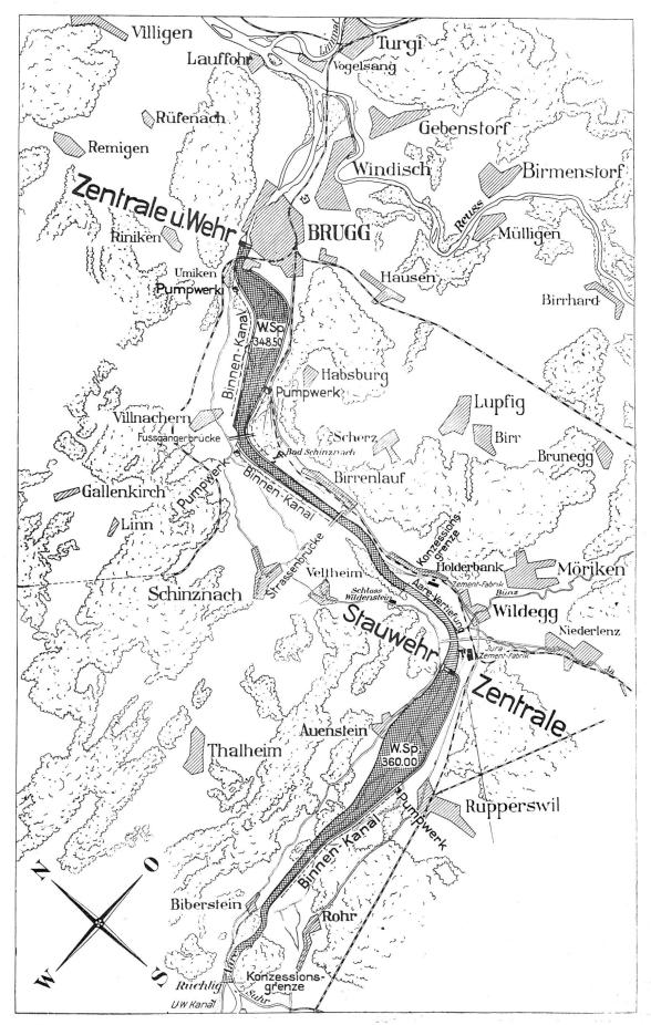
Abb. 1. Uebersichtskarte des Projektes Affeltranger/Wyss für die Ausnützung der Aarestrecke Rüchlig-Brugg. Maßstab 1:75 000.
