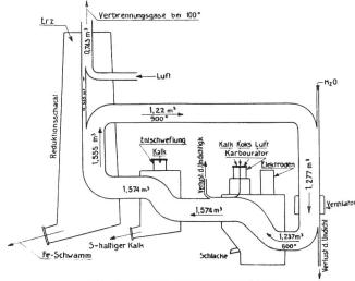
Abb. 5. Schema eines Wiberg-Ofens.
