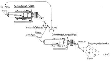
Abb. 2. Schema der Eisenschwamm-Erzeugung nach Prof. Kaling.
