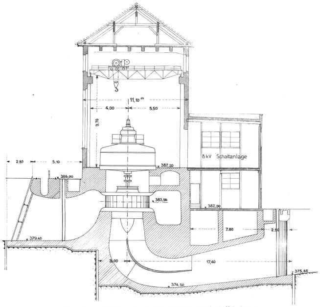
Abb. 5. Kraftwerk Dietikon. Querschnitt durch das Maschinenhaus. Maßstab 1:200.
