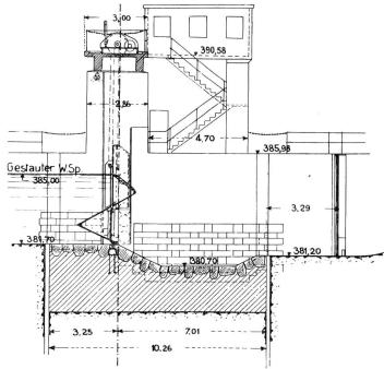
Abb. 3. Kraftwerk Dietikon. Schnitt durch das Stauwehr. Maßstab 1:200.
