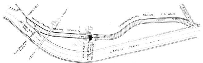
Abb 2. Kraftwerk Dietikon. Situation der Kanslstrecke. Maßstab 1:8000.
