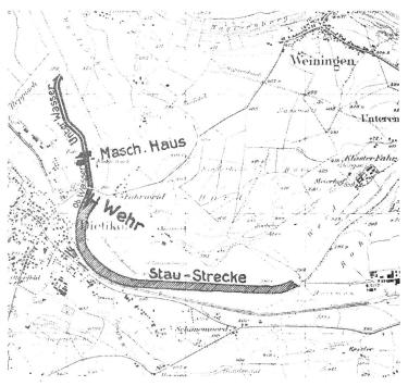
Abb. 1. Kraftwerk Dietikon. Gesamtüberblick der Anlage. Maßstab 1:35 000.
