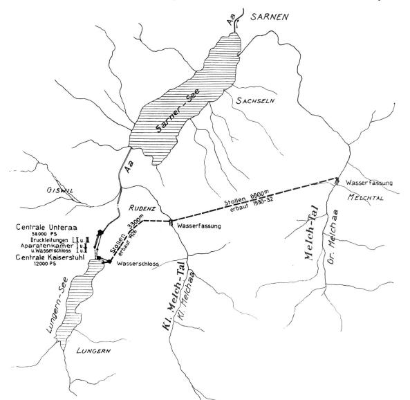
Abb. 1. Lungernseewerk. IV. Ausbau. Übersichtsplan der Gesamtanlagen. Maßstab 1:100 000.
