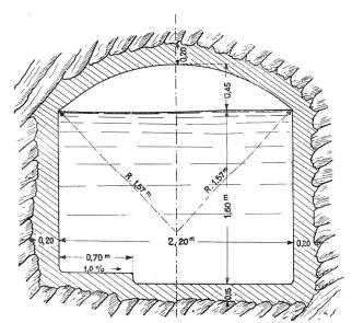
Abb. 9. Lungernseewerk, Iv. Ausbau, Normalprofil durch den Großmelchaa-Stollen (bei kompaktem Fels bleibt das Gewölbe unverkleidet). Maßstab 1:42.
