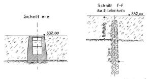
Abb. 5. Lungernseewerk IV. Ausbau. Wasserfassung und Entsandungsanlage in der Großen Melchaa. Längen- und Querschnitte. Maßstab 1:400.
