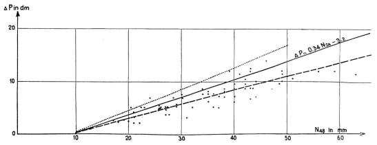
Fig. 4. Zusammenhang zwischen maximalem  $\triangle P$  und  $N_{48}$  für den Rhein bei Basel.
