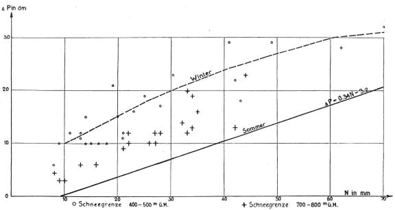
Fig. 7. Zusammenhang zwischen Niederschlag und Pegelstandserhöhung bei Warmfronteinbrüchen.
