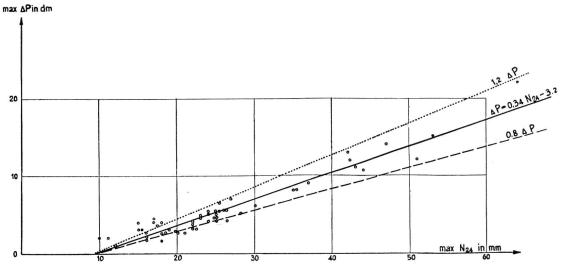
Fig. 3. Zusammenhang zwischen maximalem  $\triangle$  P und maximalem Niederschlag  $N_{24}$  für den Rhein bei Basel (Schifflände).
