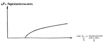
Fig. 1. Zusammenhang zwischen maximalem Pegelzuwachs und Niederschlag pro L.-Stunde bei einfachen Flußläufen an einer Station mit parabolischer Abflußmengenkurve.
