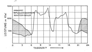
Abb. 10 Belastungskurve eines Elektrizitätswerks mit elektrischer Küche und mit Boiler.
