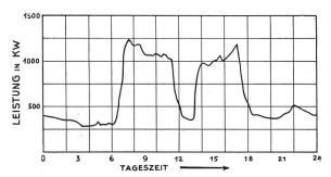
Abb. 7 Belastungskurve eines Elektrizitätswerks ohne elektrische Küche.
