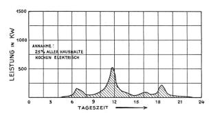
Abb. 8 Belastungskurve der elektrischen Küche (ohne Boiler) allein.
