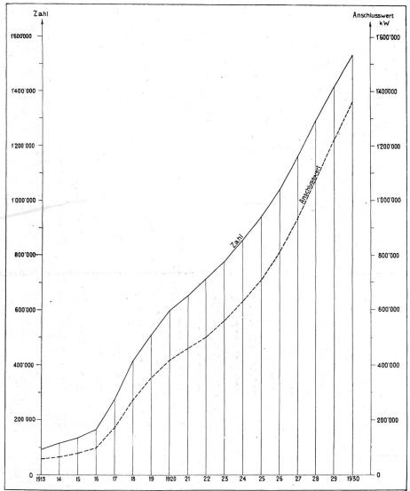
Abb. 1. Anschlüsse an eiektrischen warmcapparaten in der Schweiz nach kann und anschlügwert je auf Ende der Jahre 1913—1930.
