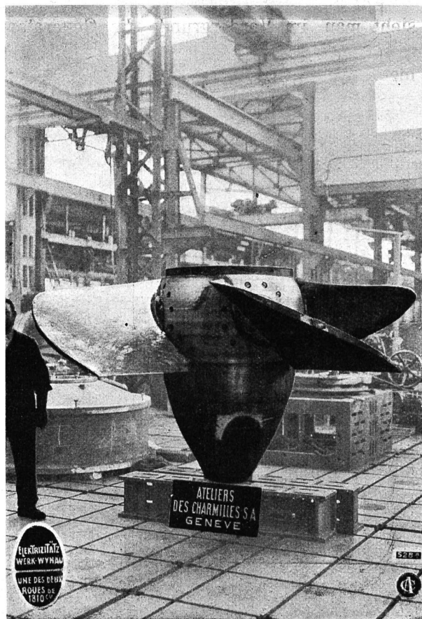
Abb. 6 und 7. Kraftwerk Wynau I. Leitapparat und Laufrad der Kaplanturbine.
