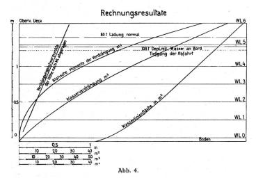
Die Berechnungen ergeben bis Oberkante Deck über Außenhaut eine Verdrängung oder Deplacement von 146,9 t
