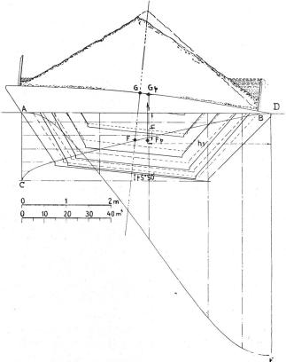
Abb. 7. Schwerpunktsverschiebung bei einer Schlagseite von  $5^{\,0}\,50^{\,\prime}$ .
