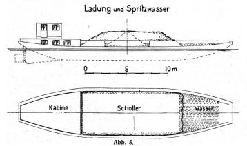
das Metazentrum über dem Gewichtsschwerpunkt liegt. Fällt es unter G, so ist Gefahr des Kenterns vorhanden. Je höher es über dem Deck liegt, desto schwerer wird das Schiff kentern. Mit den verschiedenen Schiffsneigungen ändert sich natürlich, je nach der Form des eingetauchten Schiffes, auch die Lage des Formschwerpunktes und damit auch die Höhe des entsprechenden Metazentrums.
