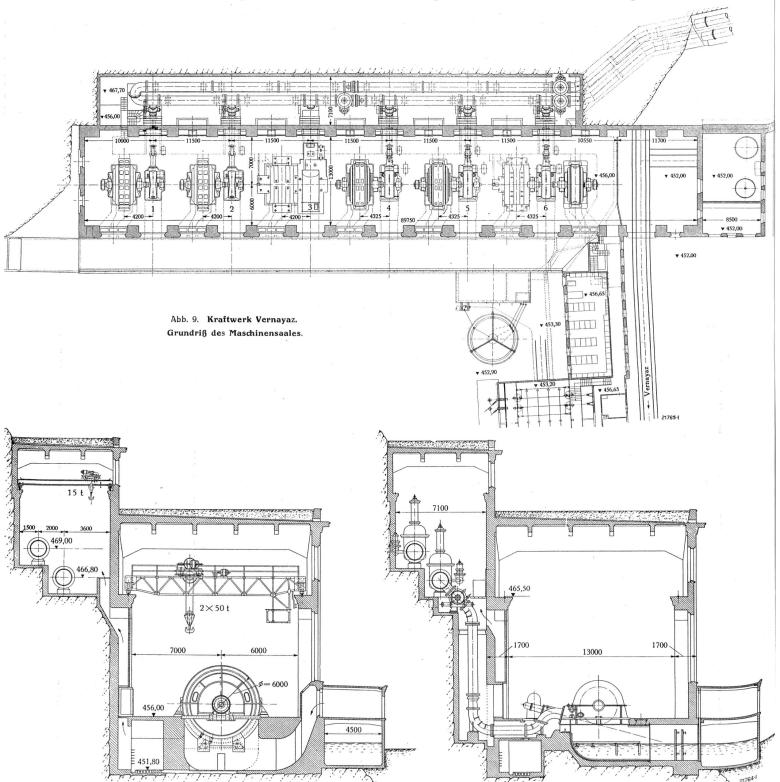
Abb. 10. Kraftwerk Vernayaz. Querschnitte durch Maschinensaal und Rohrleitungshaus.
