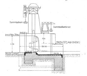
Abb. 2. Querschnitt des Stauwehrs. Maßstab 1; 750.
