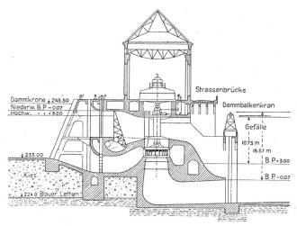
Abb. 4. Querschnitt des Maschinenhauses. Maßstab 1:750.
