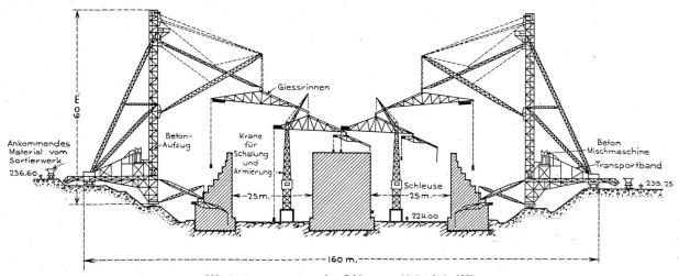
Abb. 7. Betonieranlage der Schleusen. Maßstab 1:1250.
