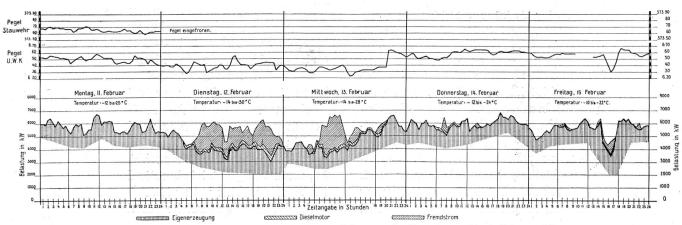
Abb. 24. Elektrizitätswerk der Stadt Aarau. Belastung der Zentrale. 11. bis 15. Februar 1929.
