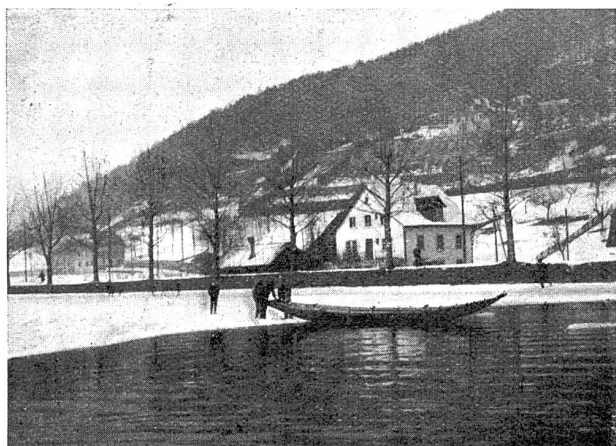
Abb. 25. Das Eis wird durch den Druck des Schiffes abgesprengt.
