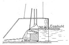
Abb. 60. Kraftwerk Rüchlig. Stauwehr, Oeffnung 1 links, von unten. (Der Ueberfall entsteht periodisch durch die Schwankungen der oberliegenden Werke.)
