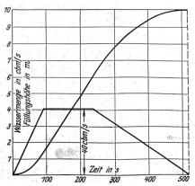
Abb. 6. Füllung durch Anheben des Tores.
