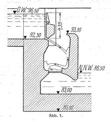
durchbrochenen Querwand zwischen dem Drempel und der eigentlichen Schleusenkammer gebildet wird, vorgesehen. Zur Erprobung des neuen Vorschlags wurde eine Reihe von Modellversuchen im Maßstab 1:50 und 1:20 der Verhältnisse der Schleuse Ladenburg der Neckarkanalisierung mit 10 m Gefälle, 12 m Breite und 110 m Länge durchgeführt 1). Als günstigste Ausbildung der Vorkammer ergab sich die Form nach Abb. 1. Zur unabhängigen Prüfung des neuen Vorschlags
