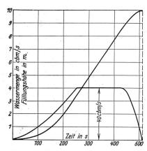
Abb. 5. Füllung durch Absenken des Tores.
