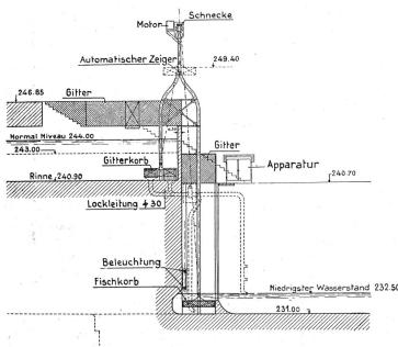
Abb. 3. Längenschnitt durch den Oberwasserkanal und das Gitter des Lifts.
